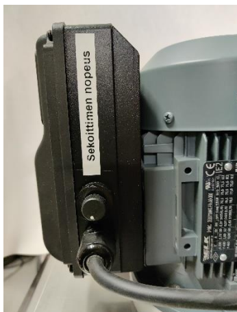
Sekoitinmoottorin nopeussäätö potentiometrillä
